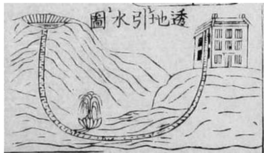
図9 『博物新編』(1855)「透地引水図」
